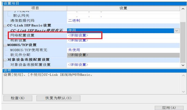
手动添加模块，在CC-Link IE Field Basic配置窗口中，将右侧IO模块直接拖曳在下方的CPU组态中，如
