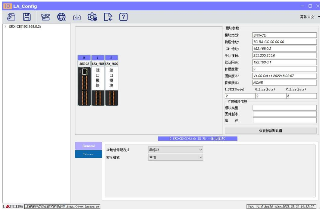
在参数设定区设定模块参数。设置完成之后点击
