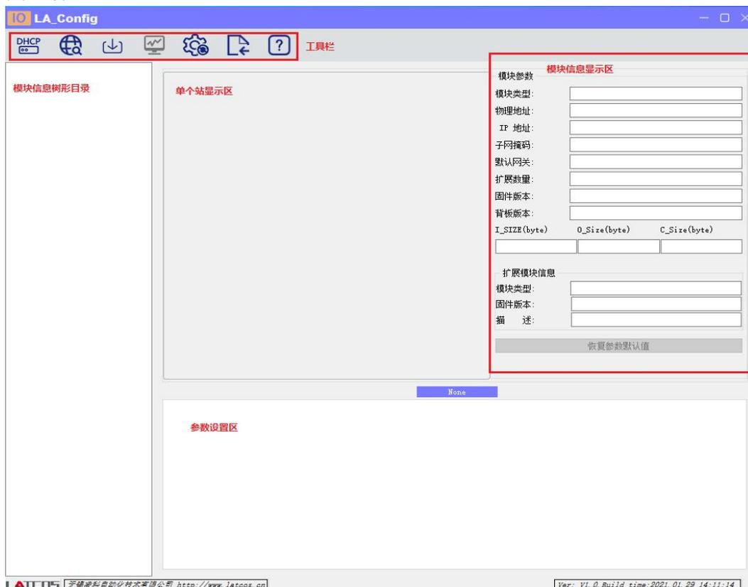
本软件界面包含了：工具栏，模块信息树形目录，参数设定区，模块信息显示区等等。
