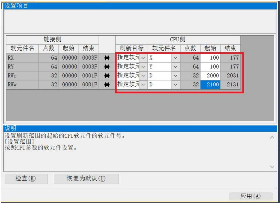
CC-Link IE Field Basic输出点映射方式：每个从站占用64个点即64DI、64DO。此处设置的输入输出点对应起始点为 X100,Y100，从站IO点的映射如图所示。
