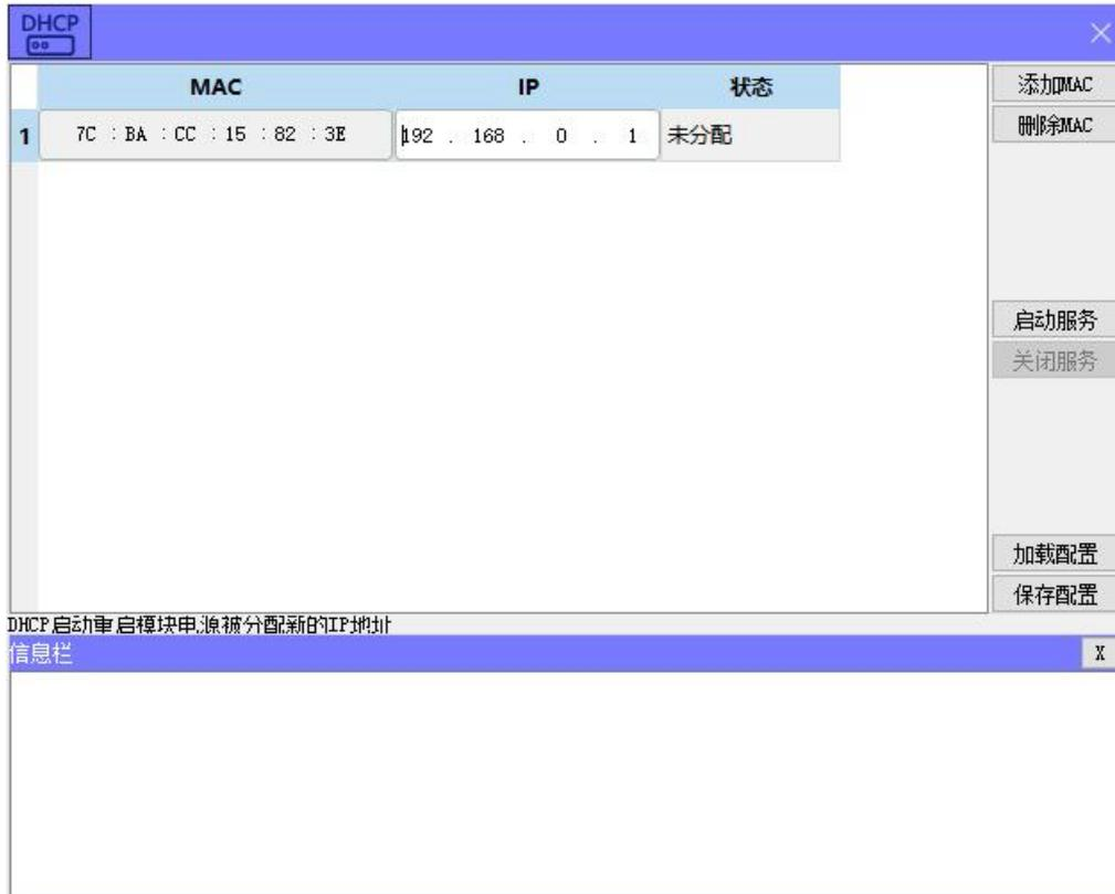
点击工具栏中的
