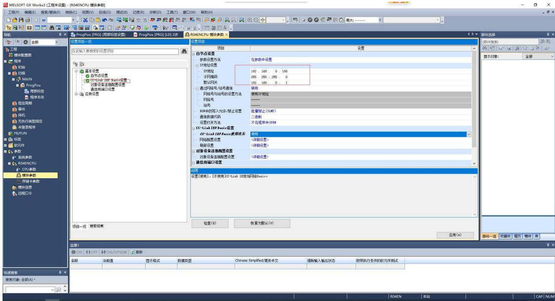
设置好主站地址及子掩码后，在 CC-Link IE Field Basic 设置窗口中勾选使用 CC-Link IE Field Basic，设置网络配置设置，如图所示。
